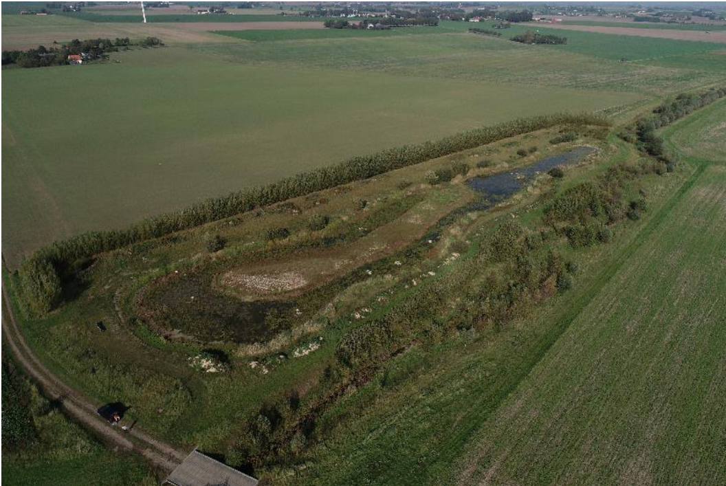
Figur 24 visar en översiktsbild. Vid fältbesöket var vattennivån i våtmarken låg, den halvö som går ut i våtmarken ligger dock på en nivå som innebär att den är under vattenytan när vattnet rinner ut vid utloppet. Notera även den häck som planteras mot åkermarken. De ljusare massorna som syns i bilden är rensmassor.
