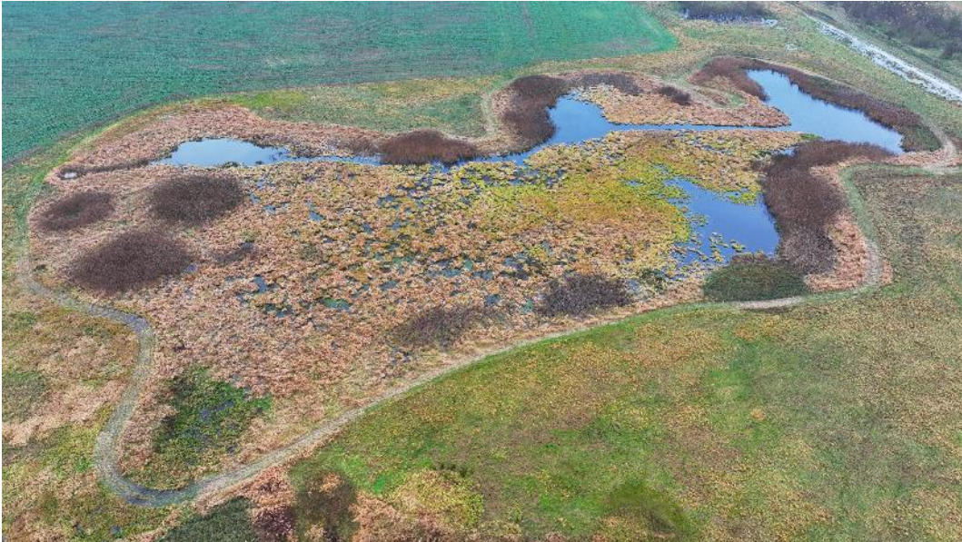
Figur 17 visar en översiktsbild över våtmarken. På bilden syns tydligt vart de djupare partierna inom området skapats genom schaktinsatser. Dammvallens massor har tagits på uppströms sida och syn i bildens övre högra hörn. Även de stora grunda områden framkommer tydligt på bilden.
